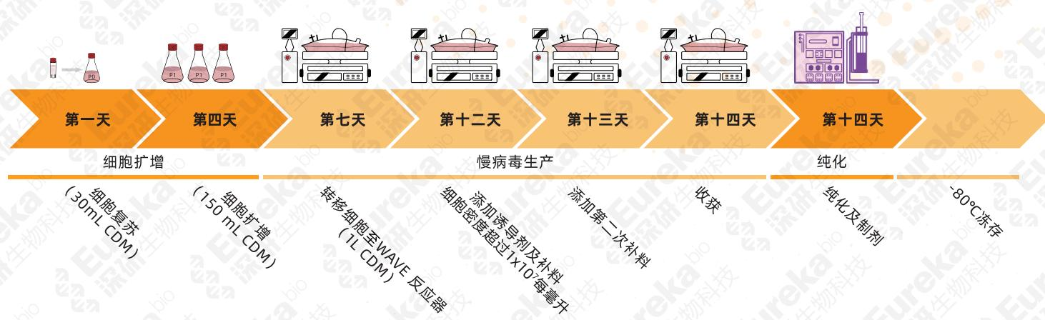
上图显示了通过EuLV®系统慢病毒载体的主要生产步骤。第1天，复苏生产细胞系，在摇瓶中培养。在细胞扩增到第7天后，将细胞转移到波浪式生物反应器中，再培养5天，当细胞密度达到每毫升 $1 \times 10^7$ 个细胞时，添加诱导剂和补料开始产生慢病毒。在第14天，收获病毒，进行纯化、制剂和分装等后续步骤。
